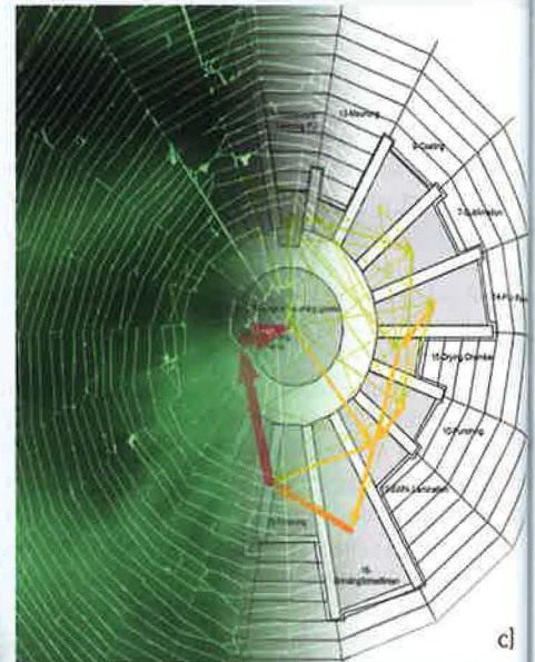
2 Biologisch inspirierte Fabriklayouts: a) Bienenwaben-Verfahren, b) Fibonacci-Verfahren, c) Spinnennetz-Verfahren
