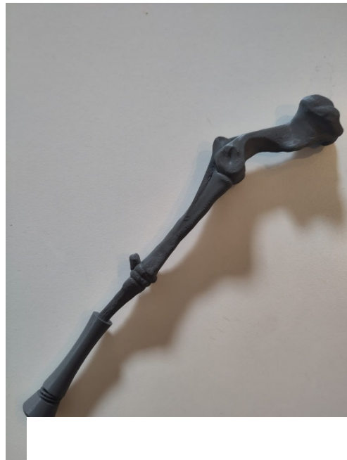
Abbildung 9: Abnehmbares Miniatur-Prothesenmodell mit Spiralfeder, und amputiertes Skelettbein, 3D-gedruckt mit PLA
