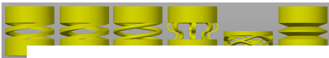
Abbildung 8 Verschiedene Federtypen; v.l.n.r.: Spiralfeder mit quadratischem, rechteckigem und kreisrundem Querschnitt, S-Feder, Wellenfeder, Tellerfeder.
